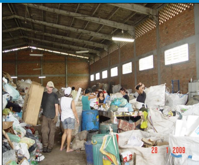
Figura 56 - Disposição dos resíduos provenientes do caminhão em meio ao galpão para posterior realização da triagem
