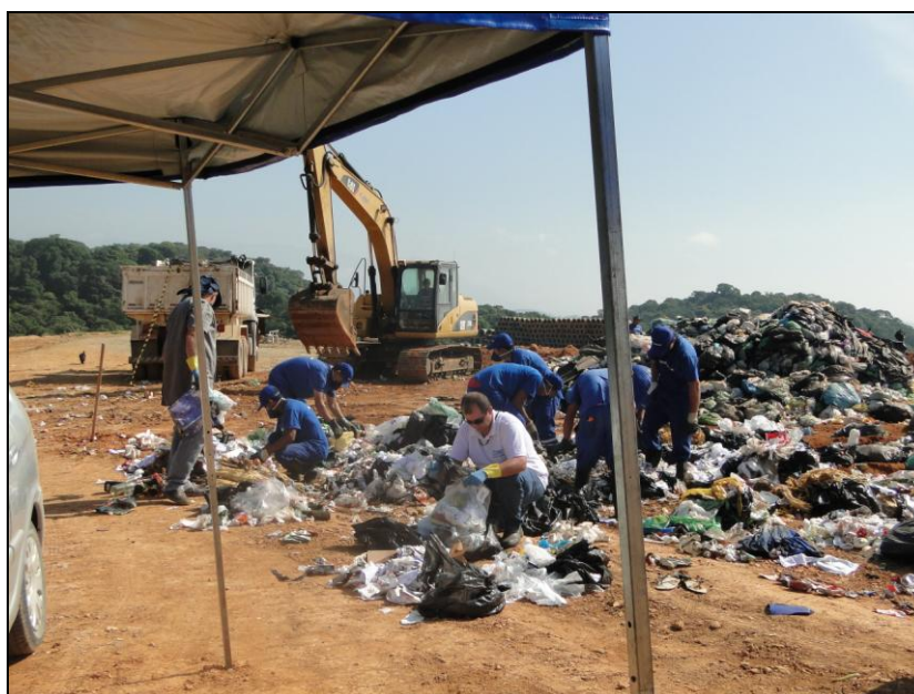
Figura 33 - Processo de quarteamento dos resíduos sólidos
