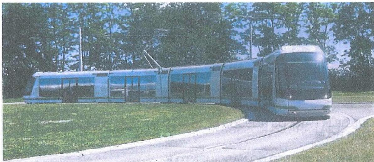
**VLP Translohr Bidirecional: 3 a 6 módulos, 25 a 46 m de comprimento, capacidade para 178 a 358 passageiros**
