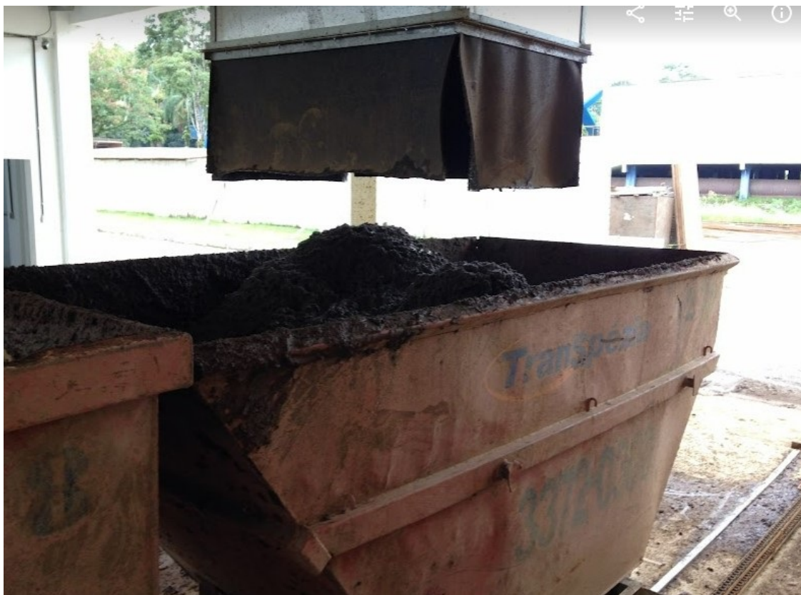
Figura 3 - Caçamba de Lodo - Lodo após processo de desague (média de 20% de Sólidos)
