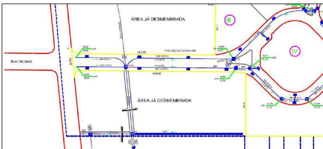
Figura 02: Integração da drenagem do empreendimento “Residencial Ecológico Orleans” ao corpo hídrico em estudo. Fonte: Unidade de Drenagem/SEINFRA, 2022.
